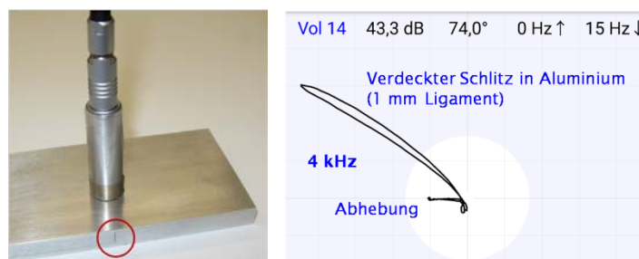
Abb. 11. Standardtastsensor auf Aluminiumschiene mit verdecktem Schlitz
