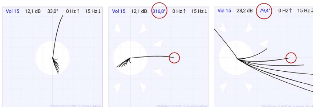
Abb. 2. Vorgehen zur Phasenbestimmung durch Drehen des Abhebesignals in die x-Achse: Links: Signalaufzeichnung, Mitte: Fe als Referenzphase, rechts: Phasenbestimmung NFe.
