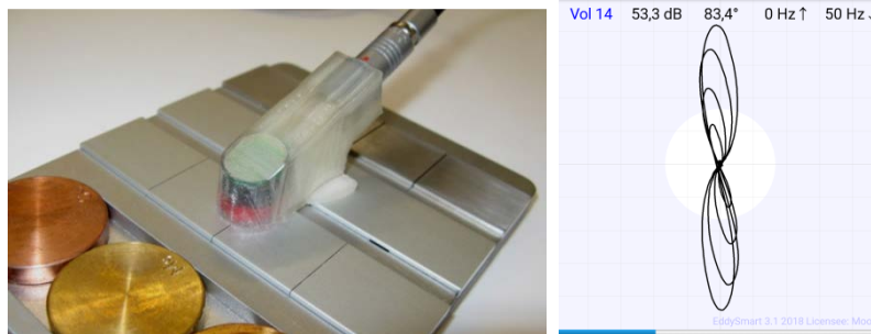
Abb. 6. Differenzsensor auf der Schlitze. Links: Sensorführung, rechts: Schlitzsignale bei optimaler Sensororientierung
