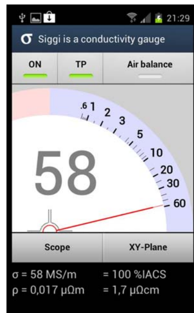
Bild 8: Wirbelstromsensor mit 3,5-mm-Klinkenstecker für ein Android-Gerät und Screenshot bei der Leitfähigkeitsbestimmung von Kupfer
