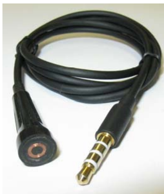
Bild 8: Wirbelstromsensor mit 3,5-mm-Klinkenstecker für ein Android-Gerät und Screenshot bei der Leitfähigkeitsbestimmung von Kupfer
