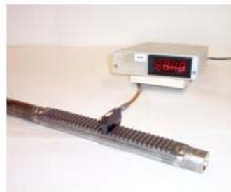
Restfeldmesssystem bei der Inspektion des Zahngrundes
