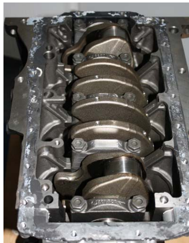
Abbildung 4-2: Lagerstuhl eines Kurbeltriebs
